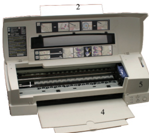
Slika 51. Osnovni dijelovi pisača Epson 1200 photo
